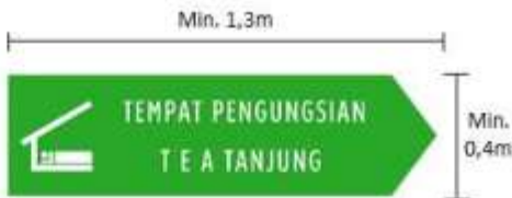
Gambar. Contoh Ilustrasi Panduan Visual Perancangan Rambu Bencana dengan Kata (ukuran min 1,3 m x 0,4 m) di Destinasi Super Prioritas Borobodu dan Sekitarnya, Provinsi Jawa Tengah
