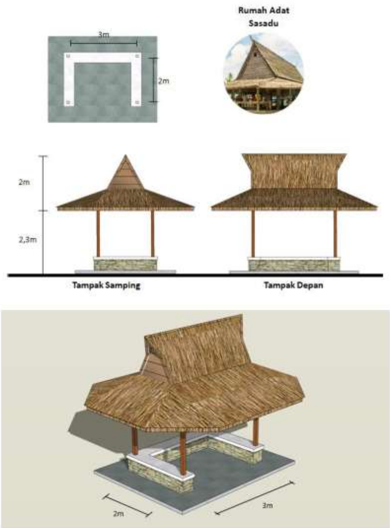
Gambar. Contoh ilustrasi panduan visual perancangan Gazebo Tipe Dua pada Kawasan Wisata Bahari dan Perairan di Destinasi Pariwisata Prioritas Morotai dan Sekitarnya, Provinsi Maluku Utara
