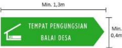
Gambar. Contoh Ilustrasi Panduan Visual Perancangan Rambu Bencana dengan Kata (ukuran min 1,3 m x 0,4 m) Kawasan Wisata Perdesaan dan Desa Wisata di Kabupaten Gianyar, Provinsi Bali
