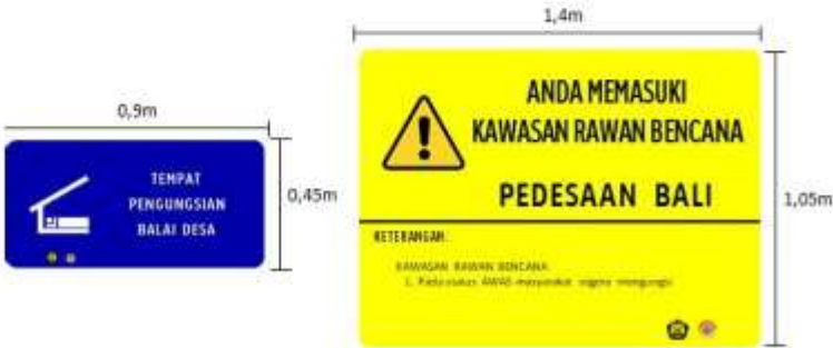
Gambar. Contoh Papan Informasi Penanda Tempat Lokasi Pengungsian (kiri: ukuran 0,9 m x 0,45 m) dan Papan Informasi memasuki Kawasan Rawan Bencana (kanan: ukuran 1,4m x 1,05 m) di Kawasan Wisata Perdesaan dan Desa
