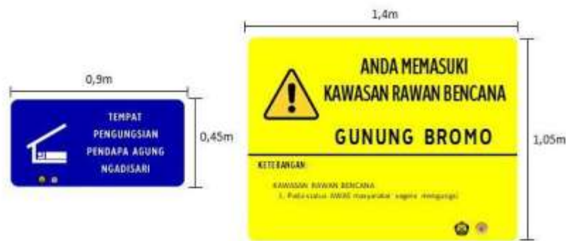
Gambar. Contoh Papan Informasi Penanda Tempat Lokasi Pengungsian (kiri: ukuran 0,9 m x 0,45 m) dan Papan Informasi memasuki Kawasan Rawan Bencana (kanan: ukuran 1,4m x 1,05 m) di Destinasi Pariwisata Prioritas Bromo-Tengger-Semeru, Provinsi Jawa Timur
