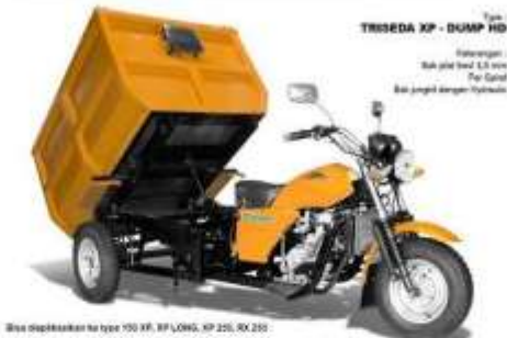
Gambar. Contoh Ilustrasi Panduan Visual Kendaraan Pengumpul Sampah Tipe Motor dengan Bak Sampah di Kawasan Wisata Alam (Nonbahari)
