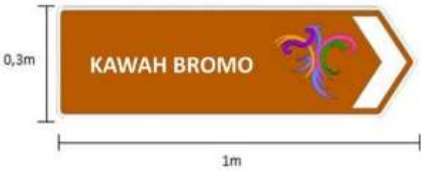
Gambar. Contoh ilustrasi Panduan Visual Perancangan Rambu Petunjuk Arah ( Signage ) di Kawasan Wisata Alam (Nonbahari), Kawasan Bromo-Tengger-Semeru, Provinsi Jawa Timur
