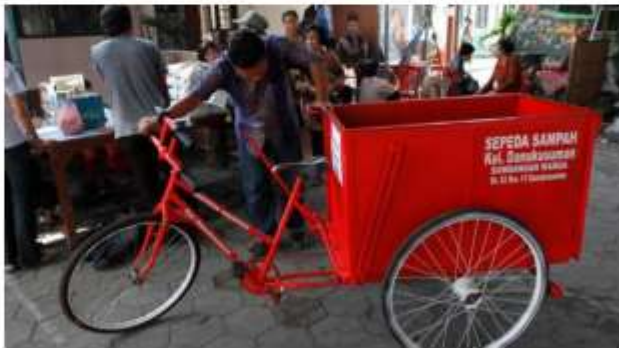
Gambar. Contoh Ilustrasi Panduan Visual Kendaraan Pengumpul Sampah Tipe Sepeda dengan Bak Sampah Besar di Kawasan Wisata Budaya dan Perkotaan
