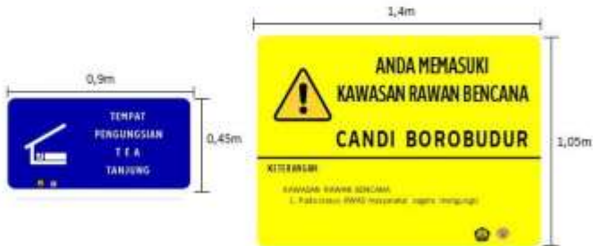
Gambar. Contoh Papan Informasi Penanda Tempat Lokasi Pengungsian (kiri: ukuran 0,9 m x 0,45 m) dan Papan Informasi memasuki Kawasan Rawan Bencana (kanan: ukuran 1,4m x 1,05 m) di Destinasi Super Prioritas Borobudur dan Sekitarnya, Provinsi Jawa Tengah
