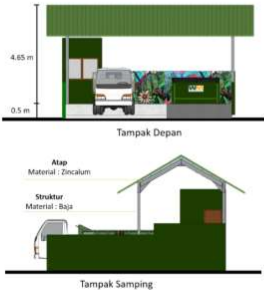
Gambar. Contoh ilustrasi Panduan Visual TPS Tipe I (ukuran kecil) di Kawasan Wisata Alam (Nonbahari)
