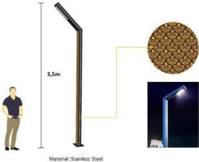
Gambar. Contoh ilustrasi panduan visual lampu taman tanpa solar panel di Kawasan Wisata Alam (Nonbahari), Kawasan Bromo-Tengger-Semeru, Provinsi Jawa Timur
