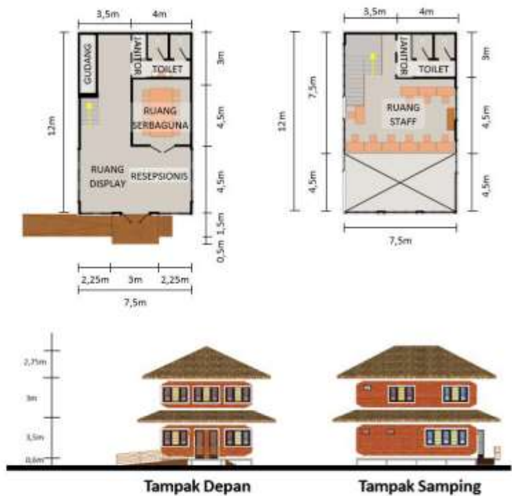
Gambar. Contoh Ilustrasi Panduan Visual Perancangan TIC (Tourism Information Center/Pusat Informasi Pariwisata) bangunan dua lantai (luas 150 m 2 ) di Kawasan Wisata Perdesaan dan Desa Wisata di Kabupaten Gianyar, Provinsi Bali
