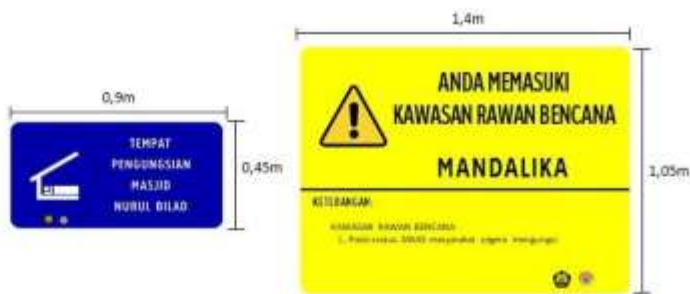
Gambar. Contoh Papan Informasi Penanda Tempat Lokasi Pengungsian (kiri: ukuran 0,9 m x 0,45 m) dan Papan Informasi memasuki Kawasan Rawan Bencana (kanan: ukuran 1,4m x 1,05 m) di Destinasi Super Prioritas Mandalika, Kabupaten Lombok Tengah, Provinsi Nusa Tenggara Barat
