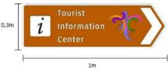
Gambar. Contoh Ilustrasi Panduan Visual Rancangan Papan Pusat Informasi Pariwisata Ukuran 1 x 0,3 m, Tipe Position Signs .
