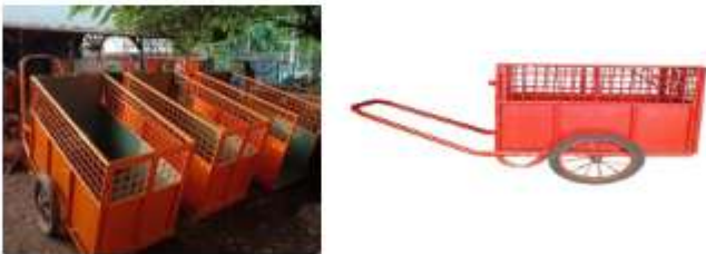
Gambar. Contoh Ilustrasi Panduan Visual Kendaraan Pengumpul Sampah Tipe Gerobak Sampah Besar di Kawasan Wisata Alam (Nonbahari)
