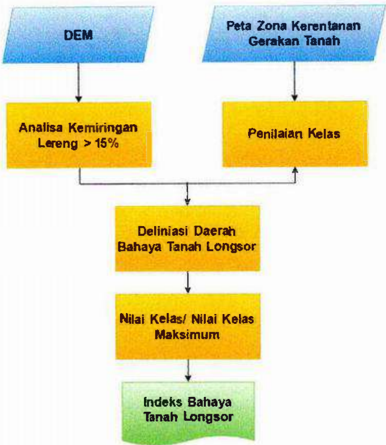
Gambar 13. Diagram Alir Pembuatan Peta Bahaya Tanah Longsor Berdasarkan Peta Zona Kerentanan Gerakan Tanah
